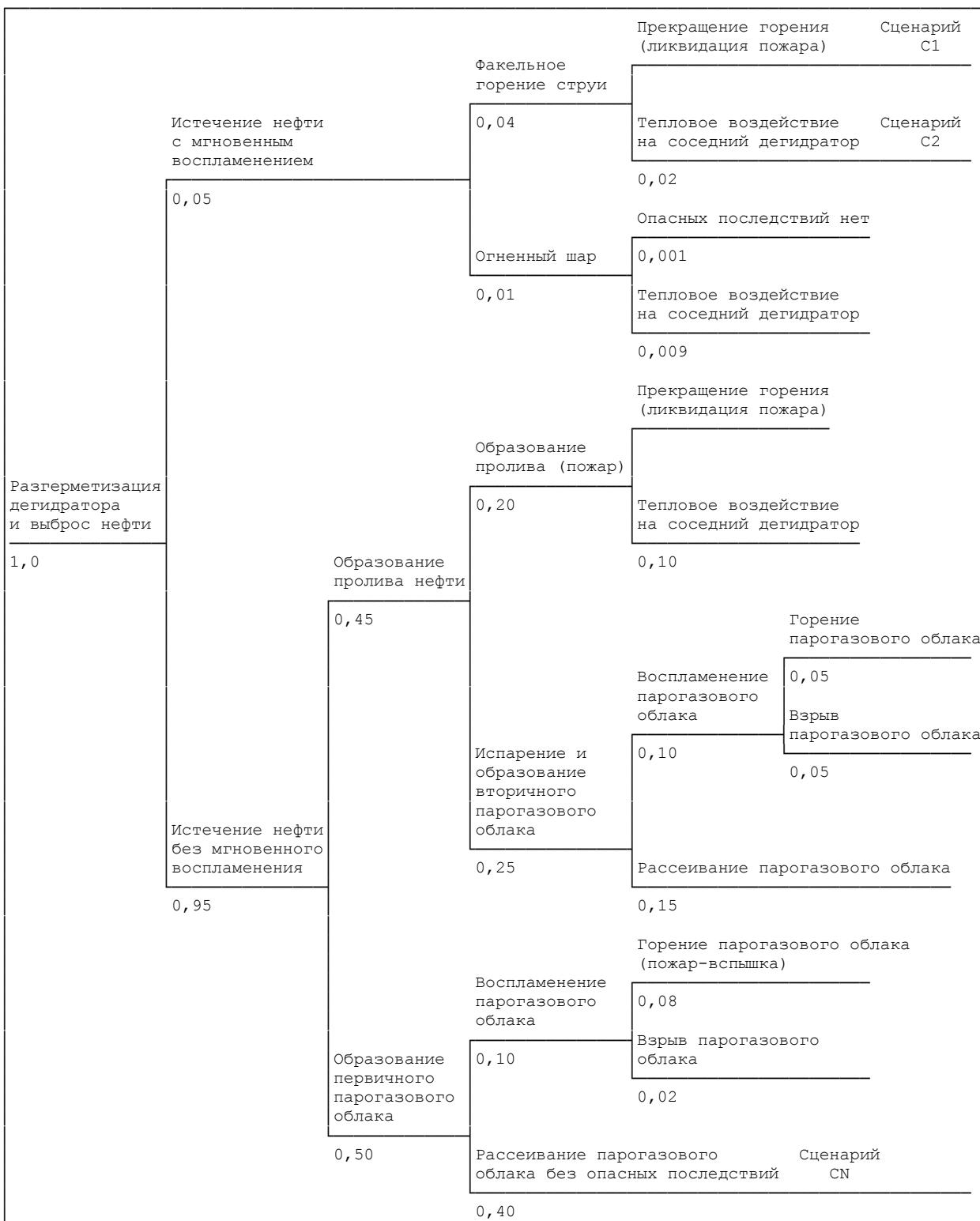
Вероятность разгерметизации дегидратора:  $P = 1 \times 10^{-4}$  год<sup>-1</sup>.
